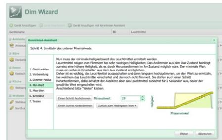
**Bild 23:** Erstellen der Dimmkurve mit dem „DimWizard“ (Quelle: digitalSTROM)
