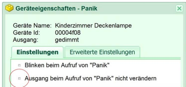
Bild 16: Abwählen und Einstellen der Funktion „Panik“ an einer Leuchte
