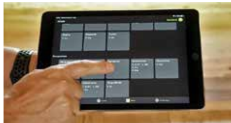
■ Beleuchtung, Beschattung, Heizung, Lüftung, Alarmanlage, Audio und Video sowie die Elektrogeräte in Küche und Waschküche können per Taster oder über eine Mobile-App gesteuert werden.
