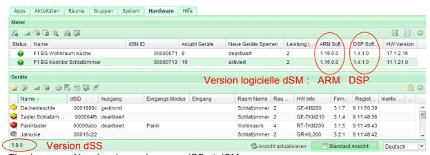
Fig. 1: Numéro de version pour dSS et dSM
