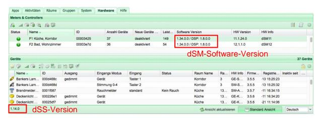
Abb. 1: Versionsnummern für dSS und dSM
