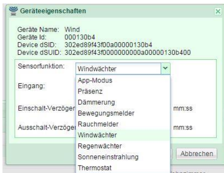
Abb. 5 Einstellen der Funktion anhand der Verdrahtung an der Wetterstation
